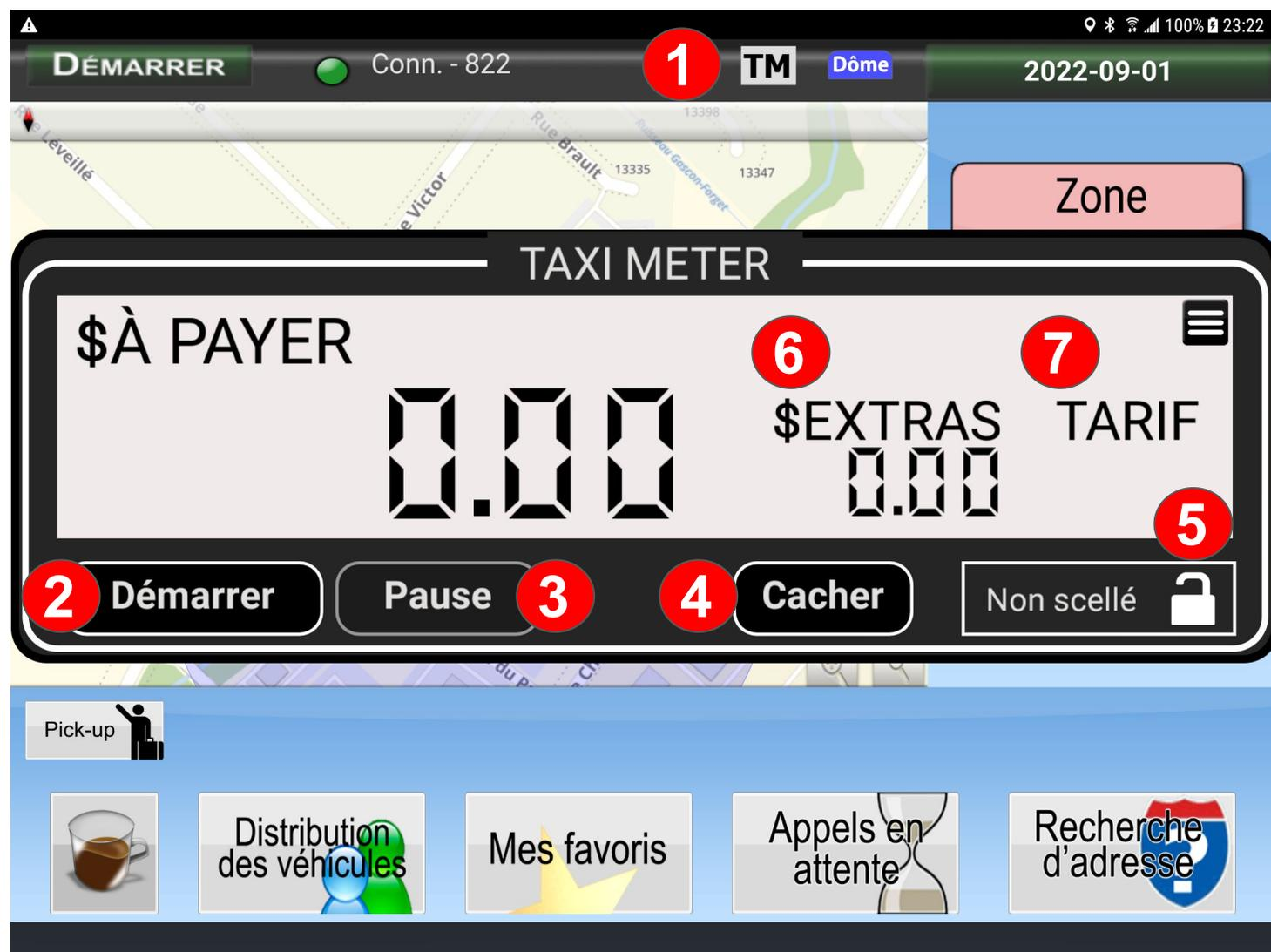
**1** Lorsque le taximètre n'est pas en fonction, l'icône est grise. Pour afficher le taximètre, cliquer sur l'icône. Quand le taximètre est en fonction, cette icône devient verte et jaune.
